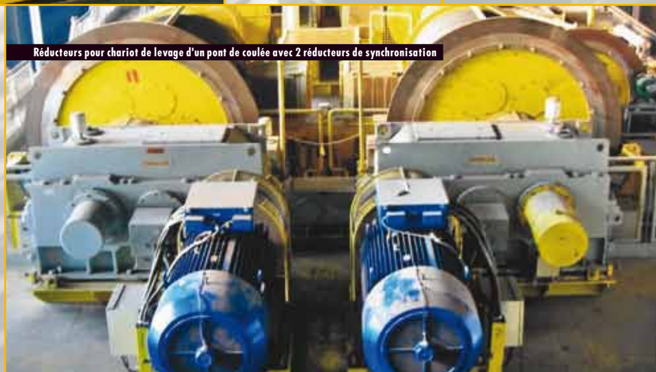
Réducteur UNIVERSEL à haute traçabilité pour le levage principal dans le bâtiment réacteur d'une centrale nucléaire
